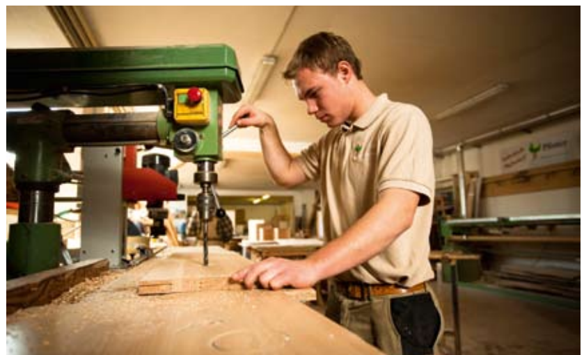
Die Beschläge müssen passgenau sitzen: Am massiven Brett werden die Bohrungen ausgeführt. Jede Küche übrigens wird komplett aus einer Hand gefertigt.
