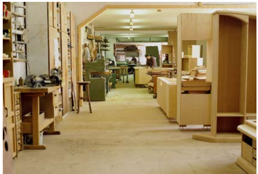
Ende der 80er-Jahre mieteten die Brüder Pfister eine Produktionshalle an, kauften sie ein paar Jahre später und erweiterten und renovierten sie 1996. Seither wird sie mit einem Feststoff-Ofen beheizt, der die Abfälle aus der Schreinerei verfeuert.
